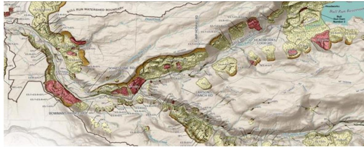
美国Oregon州基于LiDAR的滑坡图 (1:1万)
